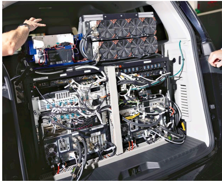
Das braucht kein Mensch! Der Kofferraum dieses Testfahrzeugs ist voller Rechner, Stecker und einem dichten Kabelsystem. In dem werden bei Testfahrten Daten gespeichert, um sie der KI zuzufüttern. Damit der VW eines Tages ganz autonom läuft, und läuft und läuft ...
