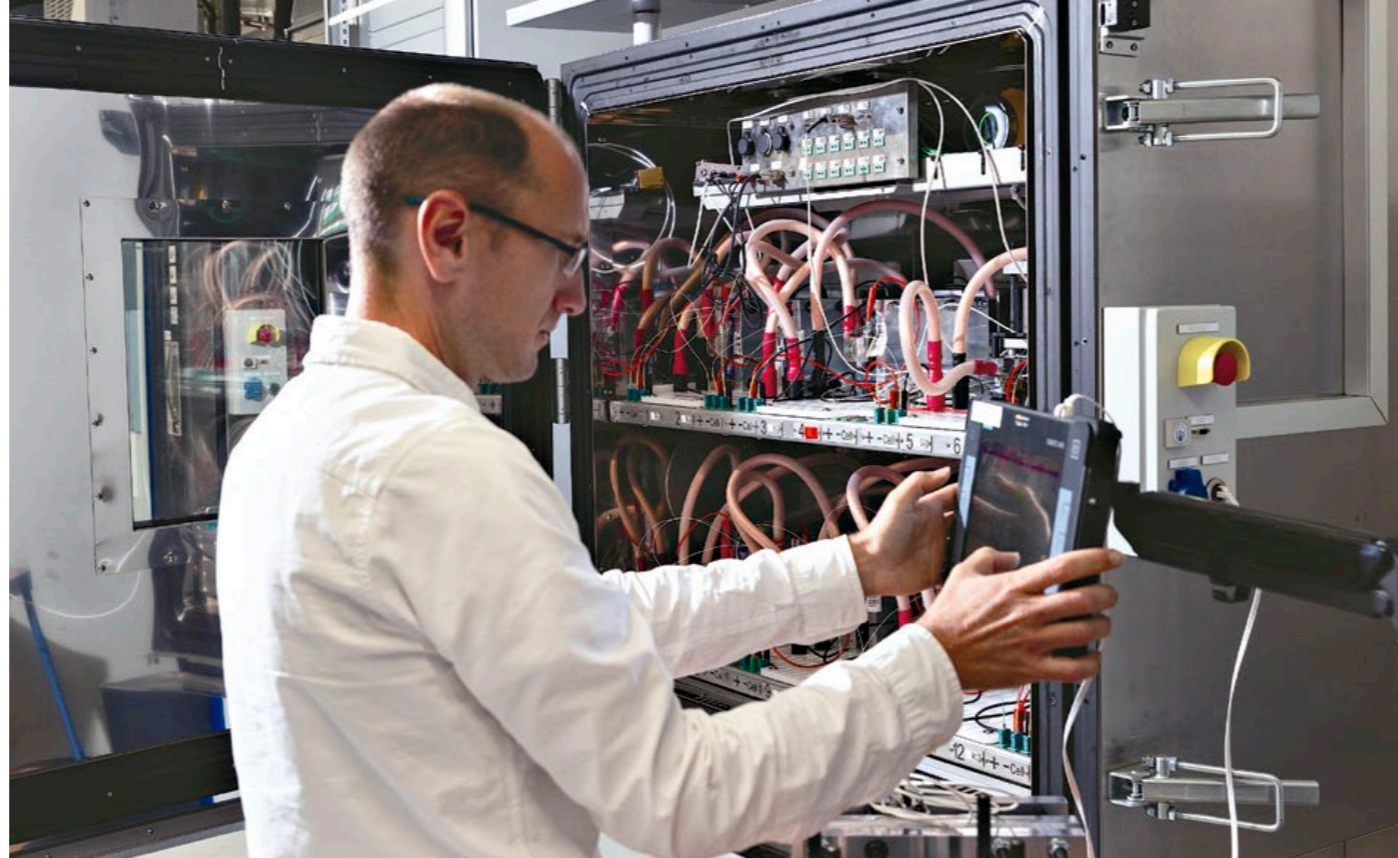
Salzgitter, wir schreiben das Jahr 2025: Ingenieur Robert Thewes testet Batterie-Prototypen im elektrischen Prüffeld (o.). In Ingolstadt sammeln Test-Busse mit Kameras, Laser- und Radarsensoren Daten fürs autonome Fahren (Mi.). Die Projektverantwortlichen Wolfgang Schmid (u. li.) und Falk Wagner (u. re.) sind auf der Suche nach der besten Zellchemie.
